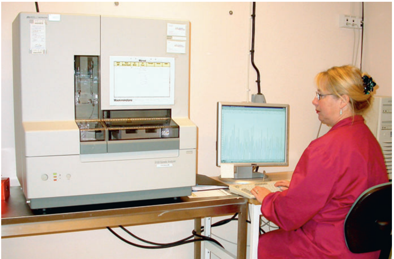
FIGUR 2A. Marianne Persson sköter utrustningen (ABI Prism 3100 Genetic Analyzer) för automatisk DNA-sekvensering genom kapillärelektrofores vid SVA/SLU.
